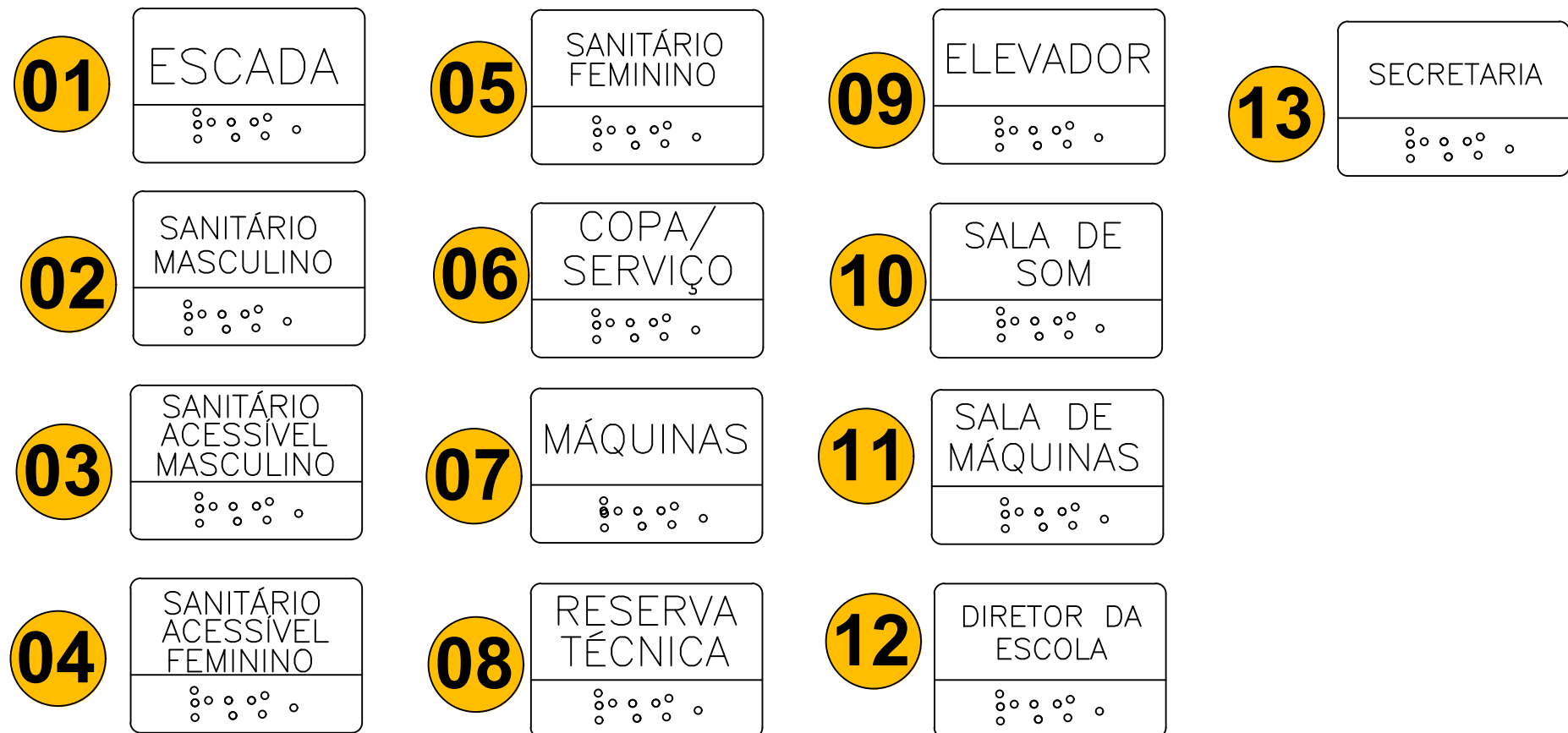
DETALHE i - ALTO RELEVO DE CARACTERES E LETRAS EM BRAILLE
