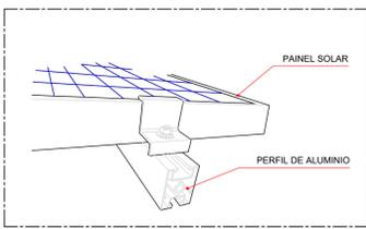
DETALHE FIXAÇÃO DAS PLACAS SEM ESCALA
